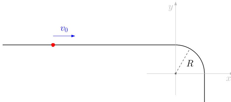
Un punto materiale si muove su una guida della forma in figura, ottenuta prolungando un quarto di circonferenza di raggio  $R$  con delle rette. Il modulo della velocità del punto è costante e vale  $v_0$ , inoltre  $x = 0$  per  $t = 0$ .
