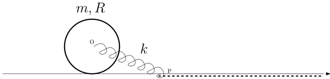
Un cilindro di massa  $m$  e raggio  $R$  è appoggiato su un piano orizzontale, e il suo centro  $O$  è collegato ad un punto  $P$  del piano da una molla di costante elastica  $k$  e lunghezza a riposo nulla. Inizialmente il punto di appoggio del cilindro si trova a sinistra di  $P$ , ad una distanza  $a$  da esso. Nella regione a sinistra di  $P$  non vi sono attriti, mentre a destra di  $P$  il cilindro è vincolato a rotolare senza strisciare. Il cilindro è inizialmente fermo.
