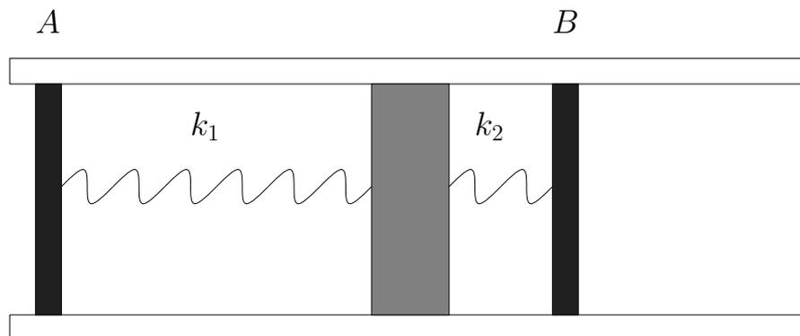
Il cilindro in figura, di sezione  $S$ , è diviso in due parti da un setto intermedio poroso e chiuso da ambo i lati da pistoni mobili ( $A$  e  $B$ ), collegati al setto intermedio da due molle di costanti elastiche  $k_1$ ,  $k_2$  e lunghezza a riposo nulla. Recipiente e pistoni sono impermeabili al calore. Inizialmente  $n$  moli di gas perfetto si trovano nello scomparto a
