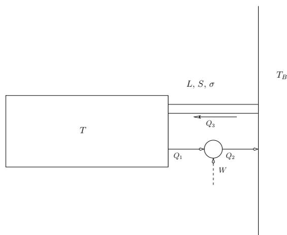
Un corpo di capacità termica costante è posto in contatto termico con un bagno termico di temperatura  $T_B$  mediante una sbarra di lunghezza  $L$ , sezione  $S$  e conducibilità termica
