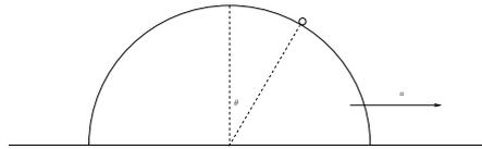
La calotta sferica in figura, di raggio  $R$  e massa  $M$ , è mantenuta in accelerazione costante  $a$  mediante una opportuna forza esterna  $F$ . Un punto materiale di massa  $m$  può scivolare senza attrito sulla sua superficie.
