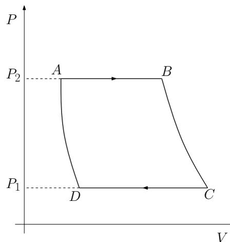
Una mole di gas perfetto monoatomico viene utilizzata per una trasformazione ciclica reversibile come in figura. Inizialmente si fa espandere il gas ad una pressione costante  $P_2$ , in modo che il rapporto tra volume iniziale e finale sia  $k < 1$ . Segue un'ulteriore espansione adiabatica che porta la pressione a  $P_1 < P_2$ , una compressione a pressione  $P_1$  costante ed una compressione adiabatica che riporta il sistema nello stato iniziale.
