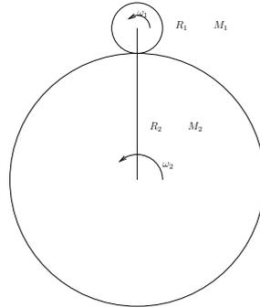
Un disco di raggio  $R_1$  e massa  $M_1$  rotola senza strisciare su un'altro, di raggio  $R_2$  e massa  $M_2$ . Il secondo disco è libero di ruotare attorno al suo centro. La distanza tra i due centri è mantenuta costante da una fune di lunghezza  $R_1 + R_2$  come in figura. È presente la gravità.
