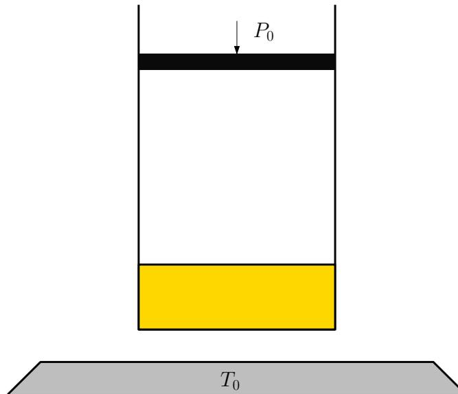
Un recipiente impermeabile al calore contiene una mole di un gas perfetto monoatomico, e un corpo di capacità termica  $C$  costante. Il recipiente è chiuso da un pistone scorrevole, pure impermeabile al calore. Si può trascurare la variazione di volume del corpo.
