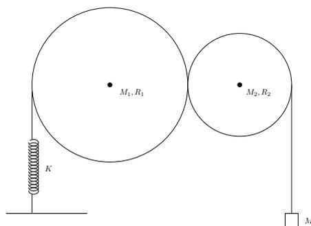
I due dischi in figura, di massa  $M_1$ ,  $M_2$  e raggio  $R_1$ ,  $R_2$  sono vincolati a ruotare intorno ai loro centri e lo fanno senza strisciare uno sull'altro. Una massa  $M$  è appesa a un filo inestensibile avvolto al disco di destra, il sinistro è collegato mediante una molla di costante elastica  $k$  e lunghezza a riposo nulla ad un punto fisso.
