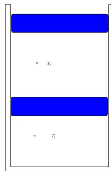
Il recipiente in figura di sezione  $S$  è impermeabile al calore e separato da due setti scorrevoli di massa  $M$ , capacità termica e spessore trascurabile. Il setto intermedio ha una resistenza termica  $R_T$ , quello in alto è impermeabile al calore. In ciascuno dei due volumi sono presenti  $n$  moli di gas perfetto monoatomico, inizialmente alle temperature  $T_1$  e  $T_2$ .
