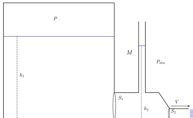
1. Che altezza  $h_2$  raggiunge l'acqua nel cilindro  $M$  se l'apertura di sezione  $S_2$  è mantenuta chiusa?
