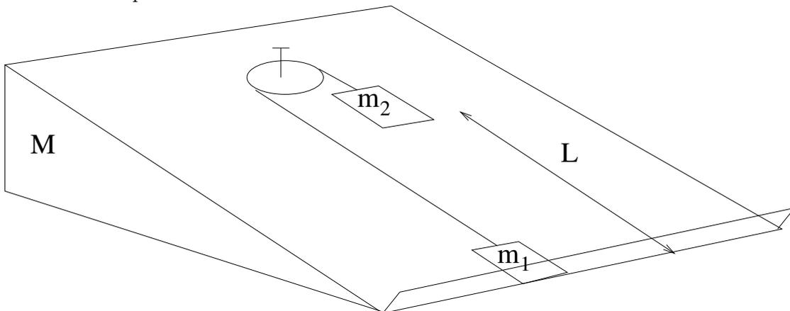
1. Se il cuneo è mantenuto immobile, determinare il moto delle masse  $m_1$  e  $m_2$  (lasciate andare da ferme).
