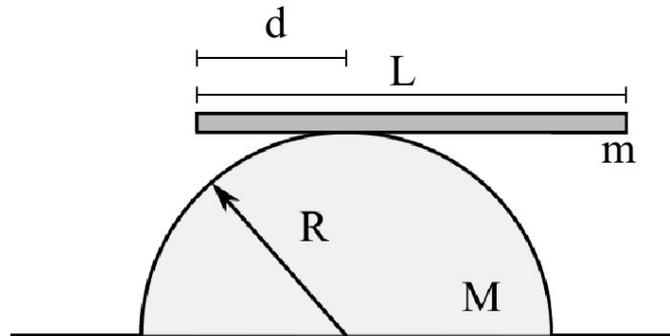
Una sbarra omogenea di lunghezza  $L$  e massa  $m$  è inizialmente appoggiata orizzontalmente su un semi-cilindro di raggio  $R$  e massa  $M$ , come in figura. La distanza del punto iniziale di appoggio dal bordo della sbarra è  $d$ . La sbarra si muove senza strisciare sul semi-cilindro. Si assuma che la sbarra non si stacchi mai dal cilindro.
