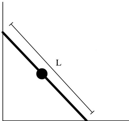
Una sbarra rigida di lunghezza  $L$  e massa trascurabile è vincolata a muoversi mantenendo gli estremi fissi su due guide perpendicolari tra loro. Al centro della sbarra è fissato rigidamente un corpo puntiforme di massa  $m$ . La sbarra è inizialmente in posizione verticale.
