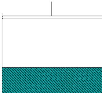
Sul fondo di un cilindro di sezione  $S$  munito di un pistone mobile e impermeabile al calore si trova uno strato di materiale di capacità termica  $C_1$ . Nella parte superiore si trovano  $n$  moli di un gas perfetto monoatomico. Inizialmente il sistema è all'equilibrio termodinamico, con pressione e temperatura  $P_0$  e  $T_0$  note.
