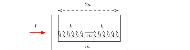
Un contenitore di massa  $m$  della forma in figura ospita al suo interno un corpo puntiforme, pure di massa  $m$ . Il corpo può muoversi senza attrito sul fondo, che ha una lunghezza totale  $2a$ , ed è fissato ai due bordi da molle di lunghezza a riposo trascurabile e costante elastica  $k$ . Inizialmente il contenitore è in quiete su un piano orizzontale privo di attrito, e anche il corpo si trova all'interno in quiete nella posizione di equilibrio.
