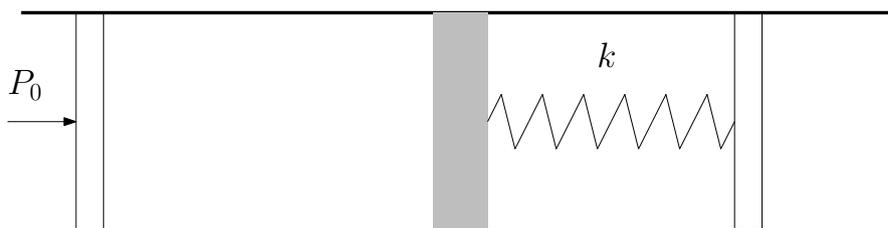
Un cilindro di sezione  $S$  con pareti impermeabili al calore è diviso in due parti da un setto che può essere attraversato dal gas. Ciascuna delle due parti è chiusa da un pistone scorrevole, pure impermeabile al calore. Il pistone a destra è collegato al setto da una
