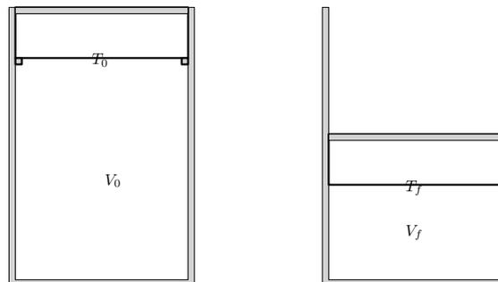
Un recipiente cilindrico di sezione  $S$  impermeabile al calore contiene  $n$  moli di un gas perfetto, ed è chiuso superiormente con un pistone scorrevole di massa  $m$  e capacità termica  $C$ . Il pistone può scambiare calore con il gas, ma il suo lato superiore è isolato termicamente, quindi non sono possibili scambi di calore con l'esterno del sistema.
