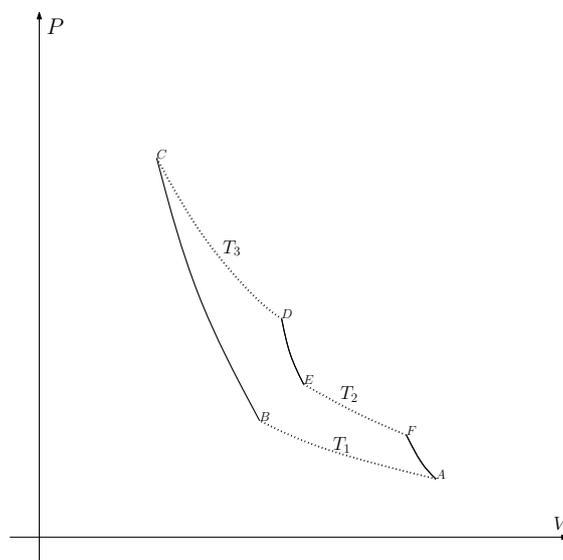
Si esegue su una mole di un gas perfetto monoatomico la trasformazione ciclica reversibile rappresentata in figura nel piano  $P - V$ . Il ciclo è composto dalle tre trasformazioni adiabatiche  $BC$ ,  $DE$ ,  $FA$  (linea continua) e dalle tre isoterme  $AB$ ,  $CD$ ,  $EF$  (linea punteggiata). Si conoscono le tre temperature  $T_1 < T_2 < T_3$  e si conoscono le entropie  $S_A$  e  $S_B < S_A$  degli stati  $A$  e  $B$
