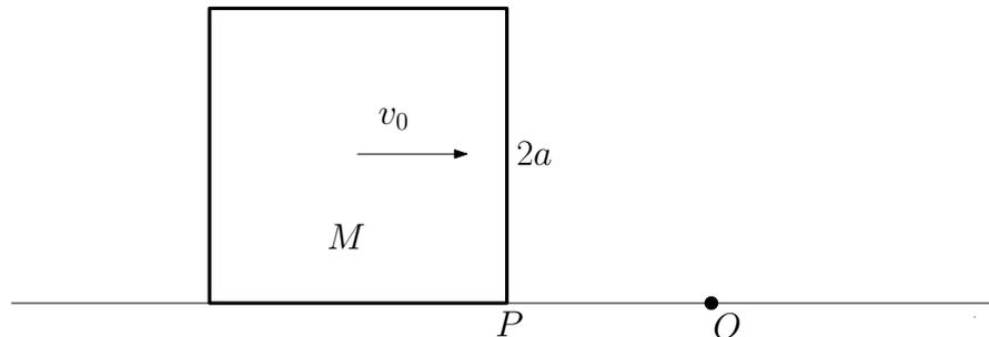
Il cubo in figura di lato  $2a$  e massa  $M$  si muove con velocità iniziale  $v_0$  su un piano privo di attrito. Può ruotare liberamente attorno al suo spigolo  $P$ , ma quest'ultimo non può staccarsi dal piano orizzontale. Nel punto  $O$  si trova un ostacolo che impedisce il passaggio di  $P$ .
