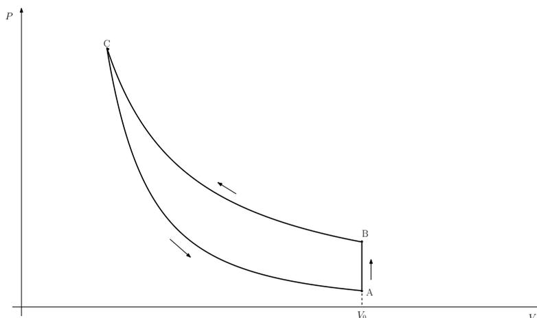
Figura 1.26.: La trasformazione termodinamica del problema. Dallo stato  $A$  (temperatura  $T_A$  e volume  $V_0$ ), viene eseguita una trasformazione isocora fino allo stato  $B$  (temperatura  $T_B$ ). Segue una compressione isoterma  $B \rightarrow C$  e una compressione adiabatica  $C \rightarrow A$ . I parametri  $T_A$ ,  $T_B$  e  $V_0$  sono noti.
