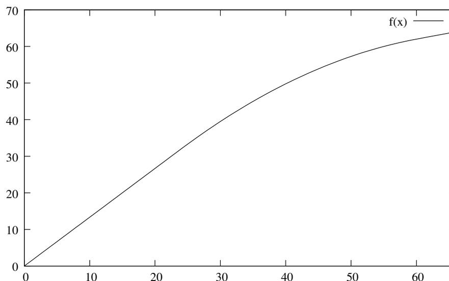
Rette e parabole si raccordano con continuità e con derivata continua.
