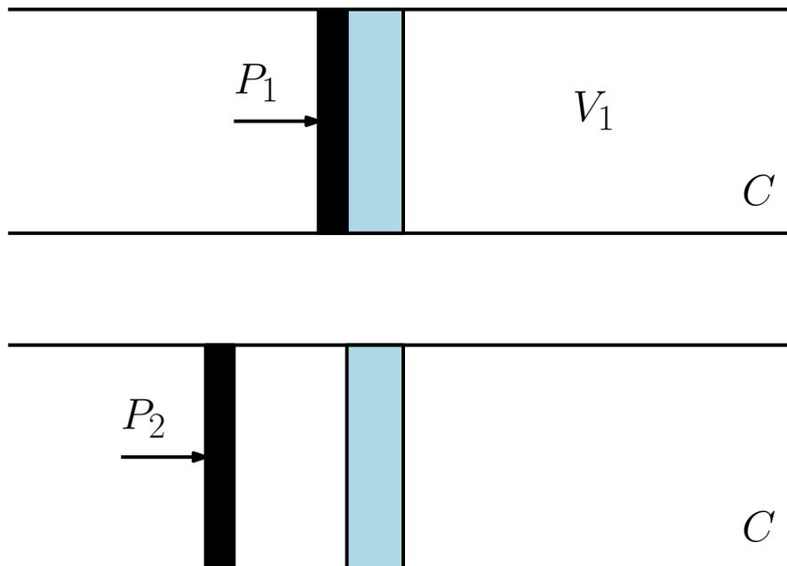
Figura 1.21.: Il cilindro, il pistone mobile e il setto poroso nello stato iniziale e in quello finale.
