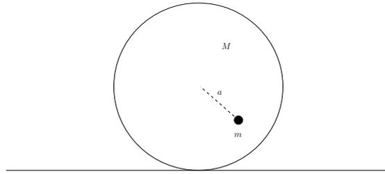
All'interno di un disco di massa  $M$  e raggio  $R$ , ad una distanza  $a < R$  dal centro, viene fissato un punto materiale di massa  $m$ . Il corpo rotola senza strisciare su un piano orizzontale.
