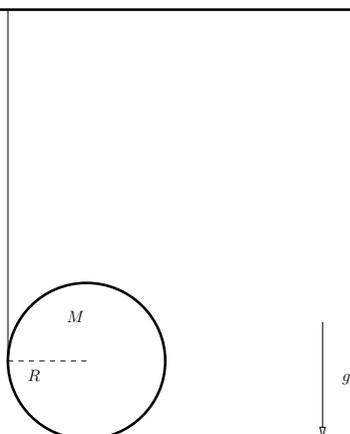
Il disco in figura, inizialmente in quiete, ha raggio  $R$  e massa  $M$ . Attorno ad esso è avvolto un filo inestensibile con densità lineare di massa  $\lambda$ . La lunghezza della parte avvolta è  $\ell$ , ed il filo è diretto verticalmente.
