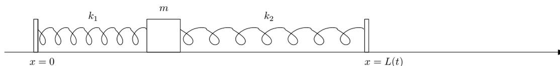
Una massa  $m$  di dimensioni trascurabili è collegata a due punti posti nelle posizioni  $x = 0$  e  $x = L(t) > 0$  da due molle di massa trascurabile, lunghezza a riposo nulla e costanti elastiche  $k_1$  e  $k_2$ .
