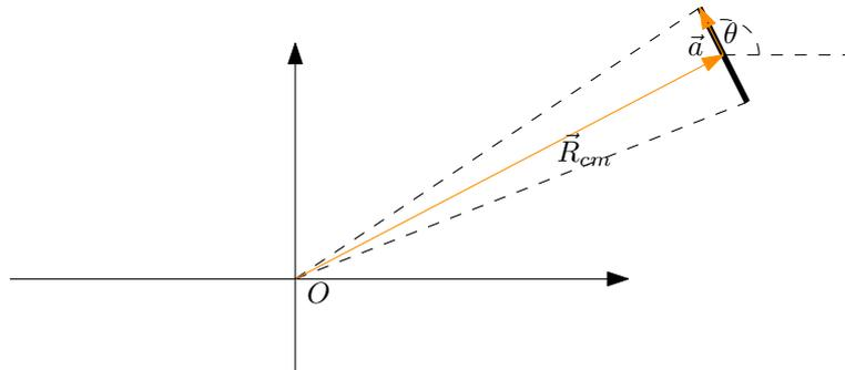
Una sbarra sottile di lunghezza  $\ell = 2a$  e massa  $m$  si muove in un piano orizzontale. I suoi due estremi sono collegati ad un punto fisso  $O$  mediante due molle di lunghezza a riposo nulla, massa trascurabile e costante elastica  $k$ . Per descrivere il sistema si scelgano le coordinate Cartesiane  $x$ ,  $y$  del centro di massa e l'angolo di inclinazione  $\theta$  della sbarra rispetto ad una direzione di riferimento. La massa è distribuita uniformemente sulla sbarra.
