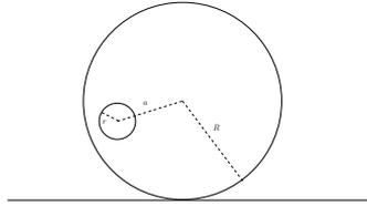
All'interno di un cilindro di massa  $M$ , altezza  $h$  e raggio  $R$  si pratica una cavità, pure cilindrica, di raggio  $r < R$  e uguale altezza. Gli assi dei due cilindri sono paralleli, e sono separati da una distanza  $a < R - r$ . Il cilindro è appoggiato su un piano orizzontale su cui ruota senza strisciare.
