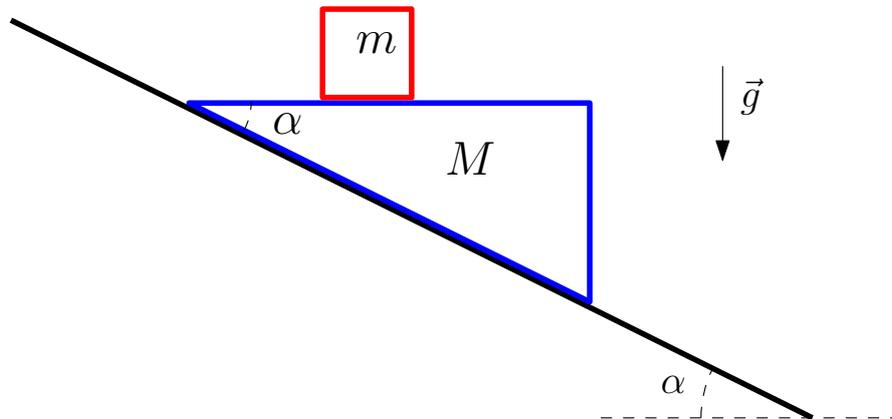
Un cuneo di massa  $M$ , con sezione triangolare retta, può scivolare senza attrito lungo un piano inclinato di un angolo  $\alpha$  rispetto all'orizzontale, in modo che una faccia del cuneo resti sempre orizzontale.
