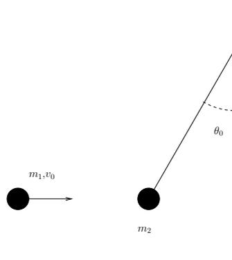
Nel sistema in figura il pendolo costituito dalla massa  $m_2$  e da una bacchetta rigida di massa trascurabile si trova, al momento dell'urto con la massa  $m_1$ , in quiete nella posizione indicata, parametrizzata dall'angolo  $\theta_0$ .
