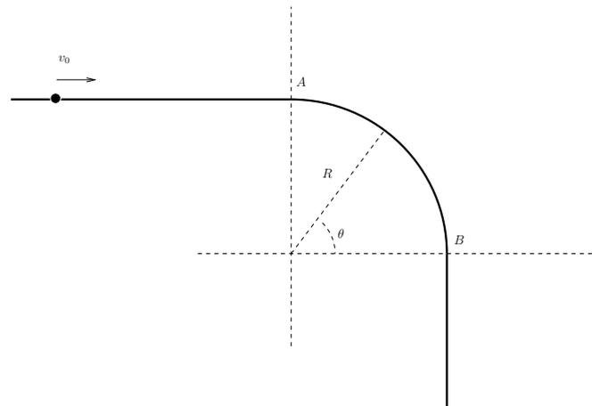
Un punto materiale di massa  $m$  è vincolato a muoversi sulla guida in figura, in assenza di attrito e sotto l'azione della forza di gravità. Il tratto compreso tra  $A$  e  $B$  è un quarto di circonferenza di raggio  $R$ . Inizialmente si trova nel tratto orizzontale, con velocità  $v_0$ .
