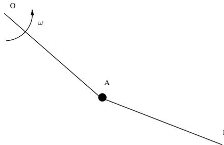
La sbarra  $OA$  in figura, di lunghezza  $\ell$ , viene mantenuta in rotazione attorno ad un suo estremo con velocità angolare costante  $\omega$ . All'estremo opposto è incernierata una sbarra di  $AB$  identica lunghezza e massa  $m$ . Il moto avviene in un piano orizzontale senza attrito.
