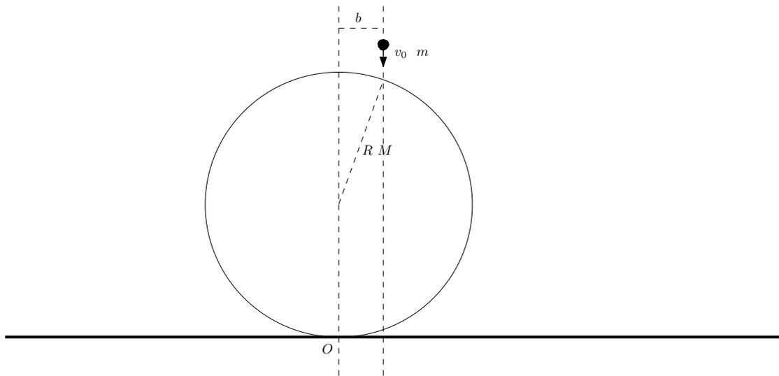
Un disco di massa  $M$  e raggio  $R$  ruota senza strisciare su un piano orizzontale. Una massa puntiforme  $m$  urta su di esso e rimane attaccato. Nell'istante immediatamente precedente l'urto la velocità del punto materiale è verticale e vale  $v_0$  in modulo. La proiezione del punto d'impatto sul piano di appoggio orizzontale si trova ad una distanza  $b$  da  $O$ .
