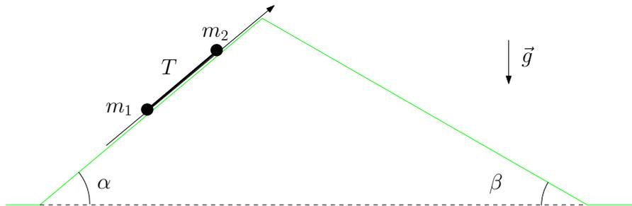
Scegliamo un sistema di riferimento come in figura. Indicando con  $x_1$  e  $x_2$  le coordinate delle due masse abbiamo
