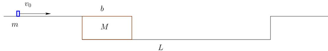
Nel sistema in figura tra il blocco di massa  $M$  e lunghezza  $b$  e la massa  $m$  è presente un attrito descritto da coefficienti statici e dinamici  $\mu_s$  e  $\mu_d$ . Inizialmente la particella si muove sul piano a sinistra (privo di attrito) con velocità  $v_0$ . Il blocco è libero di muoversi nella scanalatura, anche essa priva di attrito, e arrivando al bordo a destra vi rimane attaccato.
