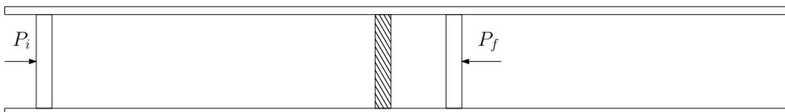
Il cilindro in figura è diviso in due parti da un setto poroso. Il cilindro è poi chiuso ai due estremi da due pistoni mobili. Pistoni e cilindro sono impermeabili al calore. Il pistone di sinistra è sottoposto ad una pressione esterna costante  $P_i$ , quello di destra ad una pressione esterna anche essa costante  $P_f < P_i$ . Inizialmente una mole di un gas non ideale caratterizzato dalla equazione di stato
