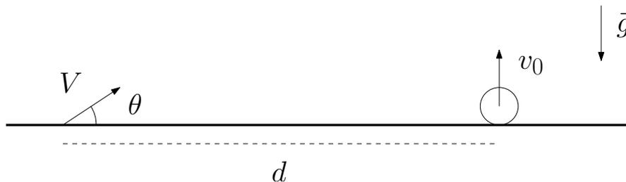
Un piattello viene lanciato verso l'alto con velocità iniziale  $v_0$ . Un tiratore, che si trova ad una distanza  $d$  dalla posizione del lancio vuole colpirlo con un proiettile che parte dal fucile con velocità iniziale  $V$ .
