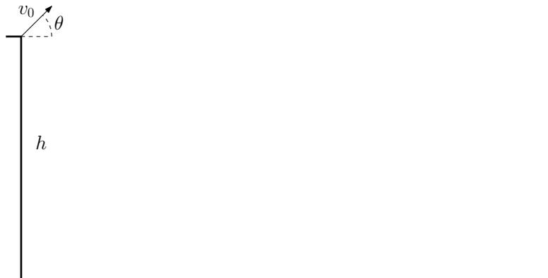
Un pallone viene lanciato con velocità iniziale di modulo  $v_0$  dalla sommità di un palazzo di altezza  $h = 40\text{m}$ . La velocità iniziale è inclinata rispetto all'orizzontale di un angolo  $\theta$ . Nel rispondere alle domande che seguono si può trascurare l'attrito dell'aria.
