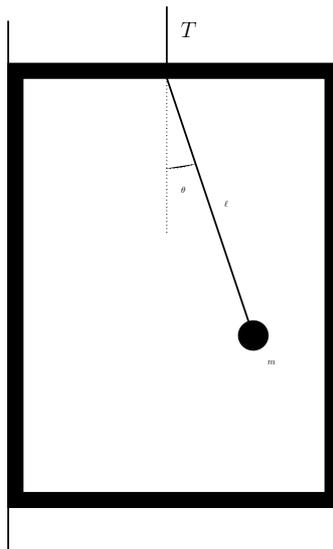
La cabina di un ascensore di massa  $M$  può muoversi in direzione verticale, ed è trattata da un cavo sottoposto ad una tensione  $T$ . All'interno di essa è fissato un pendolo costituito da una massa  $m$  sospesa a un filo inestensibile e privo di massa di lunghezza  $\ell$ . Inizialmente la cabina è ferma ed il pendolo compie oscillazioni di ampiezza angolare  $\theta_0$ , come in figura.
