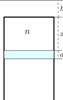
Il recipiente in figura è costituito da un cilindro di sezione  $S$  di massa e volume trascurabili, trasparente al calore, e da un pistone scorrevole di spessore  $d$  e densità  $\rho_p$ . Il cilindro contiene  $n$  moli di un gas perfetto. Il tutto è immerso in un liquido di densità  $\rho$  e temperatura  $T_0$ . Si può considerare la densità del gas trascurabile rispetto a quella del liquido, e  $\rho_p > \rho$ .
