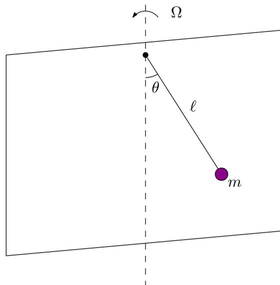
Figura 1.7.: Il pendolo sul piano in rotazione.
