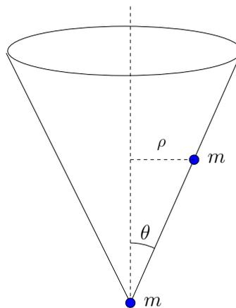
Una particella di massa  $m = 1\text{kg}$  è vincolata a muoversi sopra un cono liscio di semiapertura  $\theta = \pi/6$ . Al vertice del cono è fissata un'altra particella di uguale massa: le due particelle interagiscono gravitazionalmente.
