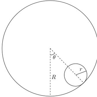
Una sfera di massa  $M$  e raggio  $r$  rotola senza strisciare all'interno di un tubo di raggio  $R > r$  come in figura. Il tubo si comporta come un vincolo monolatero.
