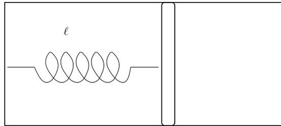
Nel cilindro di sezione  $S$  in figura sono contenute  $n$  moli di un gas perfetto monoatomico, e la molla che collega il setto mobile al fondo ha lunghezza a riposo nulla ed esercita una forza di richiamo di modulo
