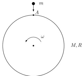
Un cilindro di massa  $M$  e raggio  $R$  può ruotare liberamente attorno al suo asse, fissato orizzontalmente. Inizialmente la sua velocità angolare è  $\omega_0$ . Ad un certo istante un punto materiale inizialmente fermo di massa  $m$  rimane attaccato in un punto  $A$  posto sul bordo del cilindro, nel punto più elevato. Il sistema si trova in un campo gravitazionale costante diretto verso il basso.
