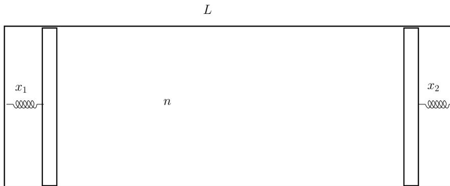
Il recipiente cilindrico in figura, impermeabile al calore, di lunghezza  $L$  e sezione  $S$ , è diviso in tre scomparti da due setti mobili. Nello scomparto intermedio si trovano  $n$  moli di gas perfetto, in quelli laterali c'è il vuoto. Gli scomparti sono collegati al recipiente da due molle di lunghezza a riposo  $L$  e costante elastica  $k$ .
