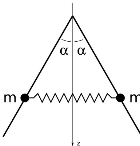
Due corpi puntiformi di uguale massa sono vincolati a muoversi lungo due guide rettilinee inclinate di un angolo  $\alpha$  rispetto alla verticale, come in figura. Le due massa
