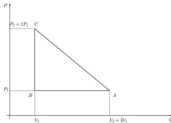
Una mole di un gas perfetto monoatomico è sottoposta alla trasformazione ciclica reversibile rappresentata in figura nel piano  $P - V$ . Si sa che  $P_2 = 2P_1$  e  $V_2 = 3V_1/2$ .
