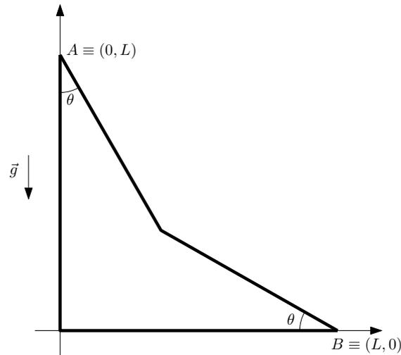
Un corpo di massa  $m$  inizialmente immobile viene lasciato libero di cadere sul doppio piano inclinato rappresentato in figura partendo dal punto  $A$ , in assenza di attrito. La giunzione tra le parti di piano con diversa pendenza è opportunamente arrotondata, in modo che la velocità del corpo si conservi in modulo attraversandola.
