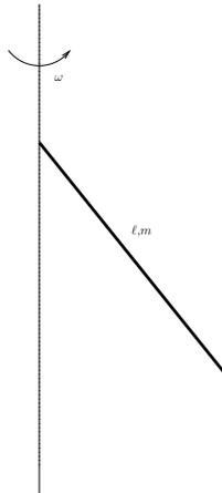
La bacchetta rigida in figura, di lunghezza  $\ell$  e massa  $m$ , ruota attorno all'asse verticale con velocità angolare costante  $\omega$ . L'angolo  $\theta$  tra asse e bacchetta è fisso.
