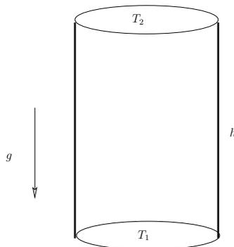
Un cilindro di sezione  $S$  e altezza  $h$  ha le pareti laterali impermeabili al calore, mentre le due estremità sono mantenute a temperatura costante. All'interno del cilindro si trovano  $n$  moli di un gas perfetto, di massa molare  $\mu$  e conducibilità termica  $\sigma$  che si suppone costante. Si deve tenere conto della gravità.
