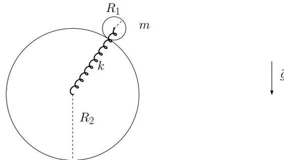
Un cilindro di raggio  $R_1$  e massa  $m$  è in contatto con un altro cilindro, di raggio  $R_2$ , che rimane fisso. Il contatto è assicurato mediante una molla di lunghezza a riposo nulla e costante elastica  $k$  collegata ai due cilindri come in figura. Inizialmente il cilindro mobile si trova alla sommità di quello fisso, e viene spostato leggermente in modo da farlo cadere.
