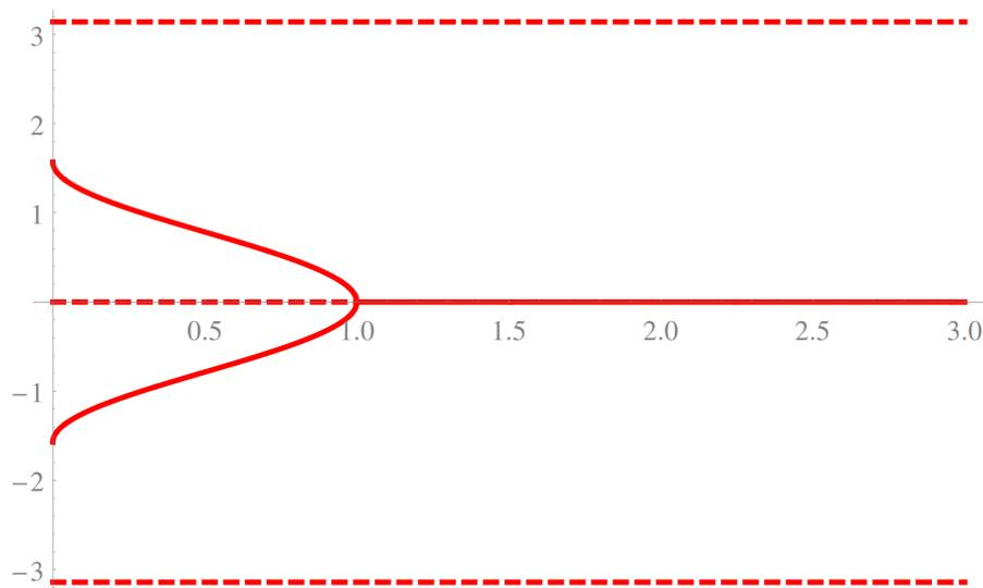
Figura 1.9.: Le posizioni di equilibrio in funzione del parametro  $\lambda = \frac{g}{\Omega^2 \ell}$ . Sull'asse delle ascisse è riportato  $\lambda$ , su quello delle ordinate il valore di  $\theta$  all'equilibrio. Una posizione di equilibrio stabile è indicata con la linea continua, una instabile da una linea tratteggiata.
