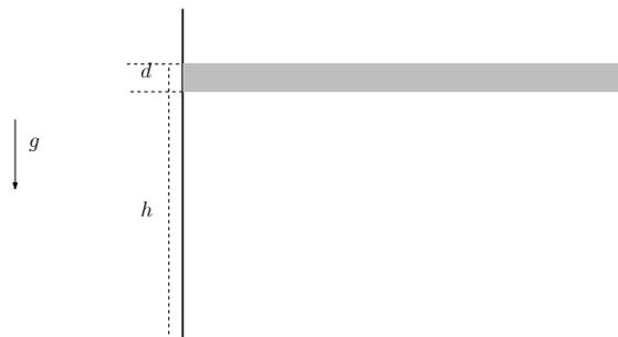
Si consideri 0.05 moli di un gas perfetto biatomico in un cilindro verticale di raggio  $R = 0.005\text{m}$  chiuso con un pistone di spessore  $d = 0.01\text{m}$  che si trova a un'altezza  $h = 0.1\text{m}$  dalla base. Siamo in presenza di gravità e in assenza di pressione atmosferica.
