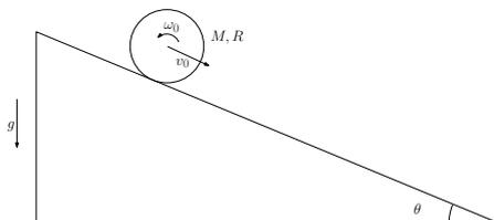
Un cilindro di raggio  $R$  e massa  $M$  si trova appoggiato su un piano inclinato rispetto all'orizzontale di un angolo  $\theta$ . Si è in presenza di attrito dinamico, caratterizzato da un coefficiente  $\mu_D$ .
