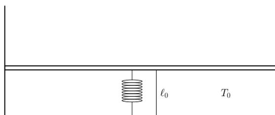
Un recipiente cilindrico è chiuso da un pistone scorrevole di sezione  $S$ , e contiene una mole di un gas perfetto inizialmente alla temperatura  $T_0$ . Recipiente e pistone sono impermeabili al calore. Il pistone è privo di massa ed è collegato al fondo del recipiente
