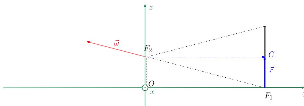
Figura 6.27.: Una costruzione che permette di determinare l'asse istantaneo di rotazione della moneta, vista in sezione trasversa ad un dato istante. Dato che sia  $F_1$  che  $F_2$  sono istantaneamente fermi, l'asse istantaneo di rotazione passa da essi.
