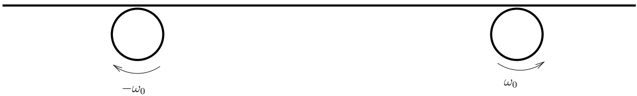
Figura 4.1: La sbarra appoggiata sui due rulli. È indicato il verso di rotazione che produce una oscillazione.
