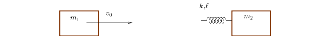
Figura 5.102.: Il modello di urto non istantaneo tra le due masse considerato nell'esercizio.
