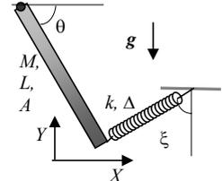
$\Delta = \dots\dots\dots = \dots\dots\dots$  m      $Mg x_{CM} \cos \theta / (kL) = 3Mg \cos \theta / (4k) = 2.45$  m [viene dall’equilibrio dei momenti delle forze rispetto al perno di rotazione, notando che le forze che danno un momento non nullo sono la forza peso  $Mg$ , applicata al baricentro e quindi con un braccio  $x_{CM} \cos \theta$  rispetto al perno, e la forza elastica, di modulo  $k\Delta$  e braccio  $L$ , essendo diretta ortogonalmente all’asta]
