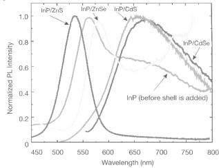
Figure 4.14. Photoluminescence spectra of InP quantum dots and the various core-shell structures involving InP core of some diameter (~3 nm). erag. 27 . เอีเอน นอกอา เน่าเอเออกเอเอิฐเอ 2001, อ
