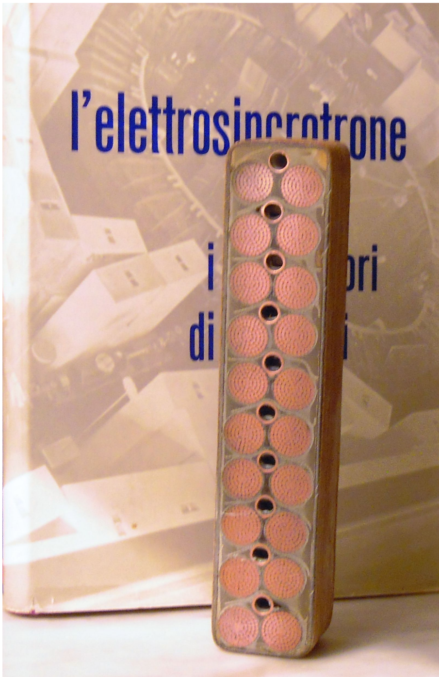
Figura 4: Sezione della bobina del sincrotrone, trasformata in soprammobile...Materiali: araldite, cavi di alimentazione in rame, tubi di raffreddamento in rame.
