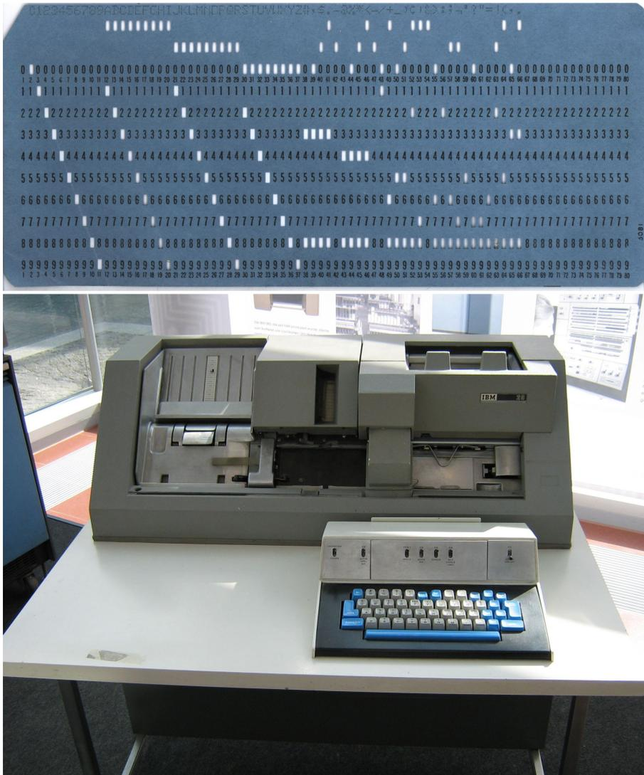
Figura 6: *Sopra: Una scheda IBM. Sotto: una punzonatrice IBM29.*
